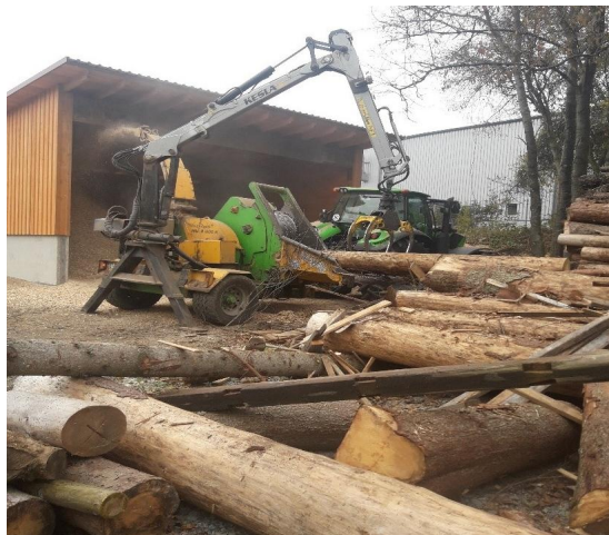
Hacker im Einsatz; im Hintergrund die neue Hackgut-Lagerhalle
